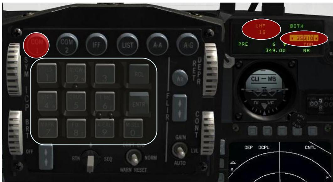
**Bild 6: manueller Frequenzwechsel auf 353.100 und bestätige mit ENTER**
